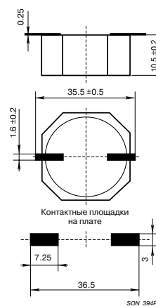
SMAT-30, конструкция для поверхностного монтажа
