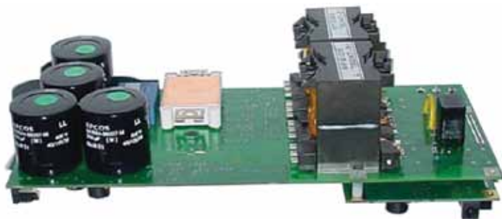
Рис. 9. Демонстрационный макет AC/DC-преобразователя с ККМ (конденсатор CeraLink – синего цвета, четыре алюминиевых конденсатора – черного цвета)
